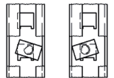
Positions admissibles de la tête de boulon
