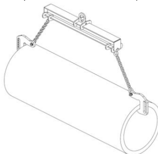
Crochets F montés sur palonnier monopoutre : permet de réduire la hauteur perdue en levage
