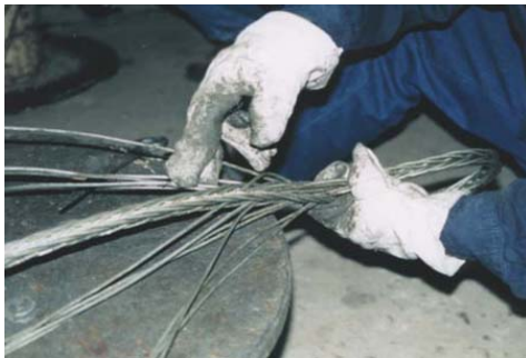
Fabrication boucle de câble tressé
